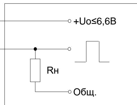
Рисунок 10 Варианты подключения нагрузки к выходу корректора
