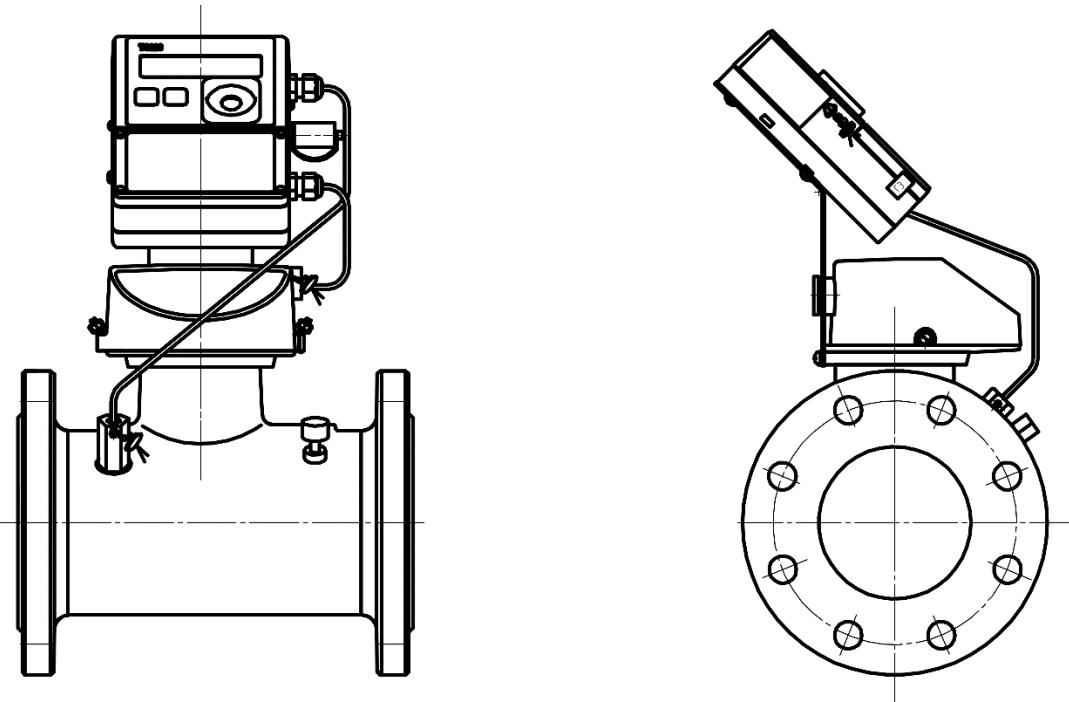
Рисунок Б2 Вариант монтажа корректора ТС220 на счетчик ТРZ
