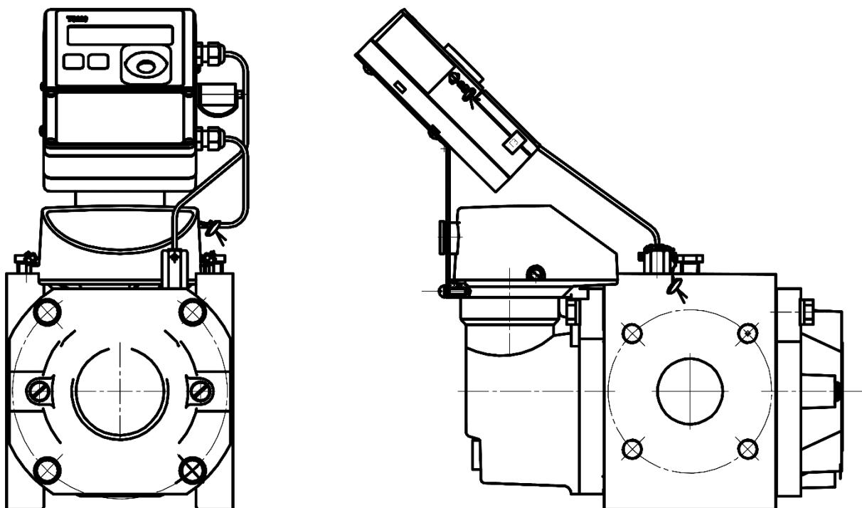
Рисунок А2 Вариант монтажа корректора ТС220 на счетчик RVG
