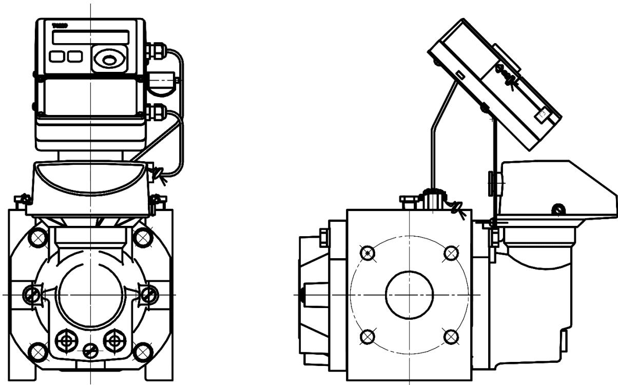
Рисунок А1 Вариант монтажа корректора ТС220 на счетчик RVG
