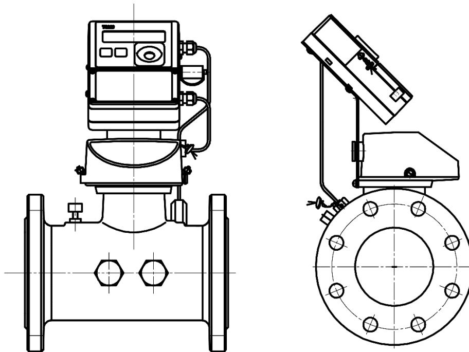
Рисунок Б1 Вариант монтажа корректора ТС220 на счетчик ТРZ
