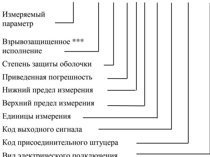
**Варианты заполнения схемы для различных исполнений датчиков**
