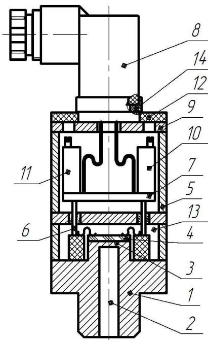
Рисунок 2 – Датчик абсолютного давления
