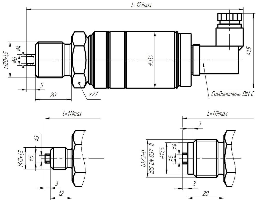
Рисунок Д.1 – Габаритные и присоединительные размеры датчиков
