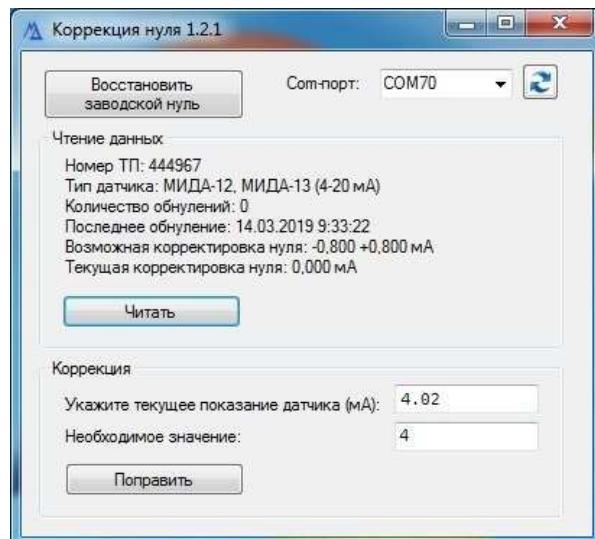
Рисунок О.3 – Окно программы после считывания данных
