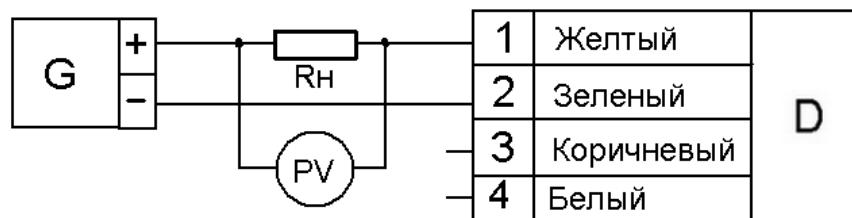
$R_H$  – нагрузочный резистор С2-29В-0,125-1 кОм $\pm$ 1 %; PV- вольтметр постоянного тока
