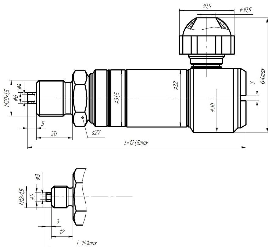
Рисунок Д.11 – Габаритные и присоединительные размеры датчиков МИДА-ДИ (ДА, ДВ, ДИВ)-15-УМ, МИДА-ДИ (ДА, ДВ, ДИВ)-15-Ex-УМ с цифровым выходным сигналом (код сигнала 061-064).
