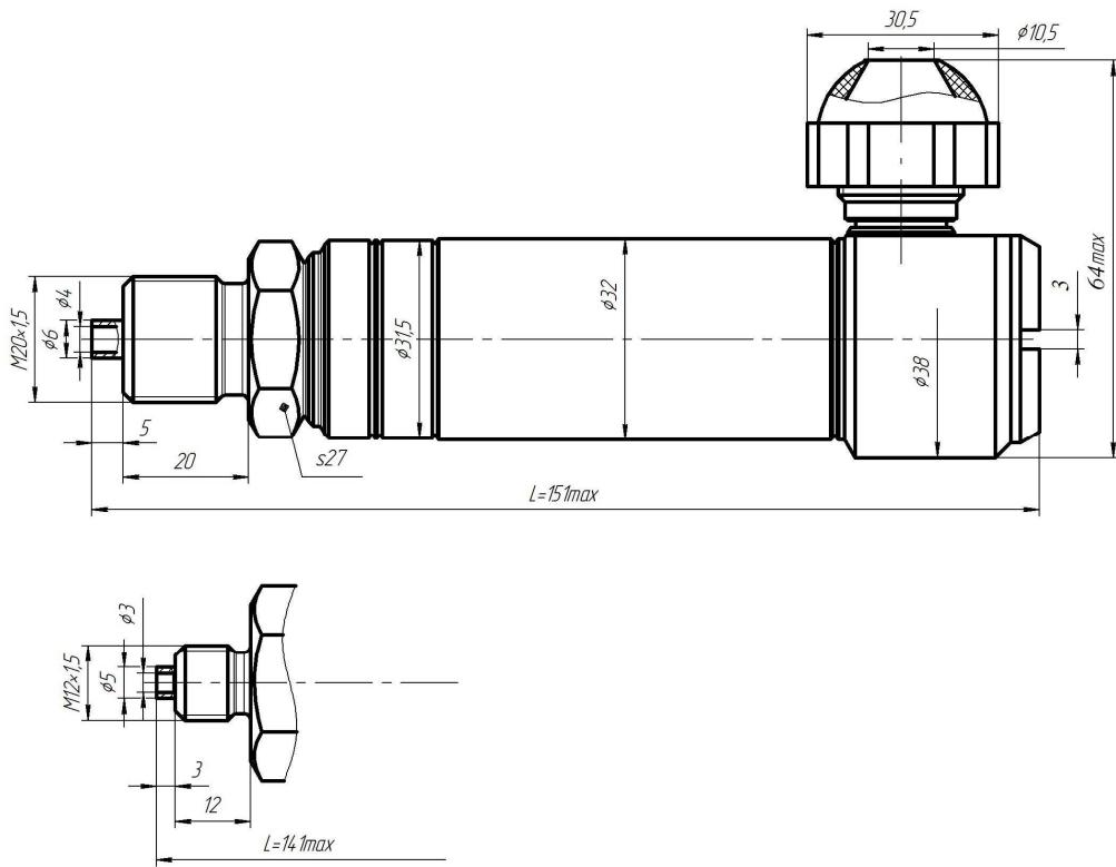
Рисунок Д.10 – Габаритные и присоединительные размеры датчиков МИДА-ДИ (ДА, ДВ, ДИВ)-15-УМ, МИДА-ДИ (ДА, ДВ, ДИВ)-15-Ex-УМ с токовым выходным сигналом и в виде напряжения постоянного тока и наличием подстройки «нуля» и «диапазона» (код сигнала 01, 051, 052, 058, 059).
