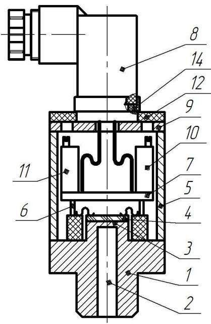
Рисунок 1 – Датчик избыточного давления
