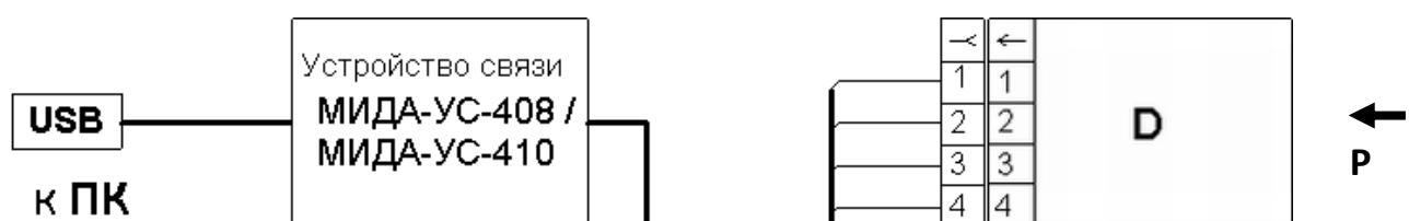
Рисунок Г.2- Схема подключения датчиков с протоколами обмена Modbus и Mida интерфейса RS485 к персональному компьютеру (ПК) для настройки и поверки
