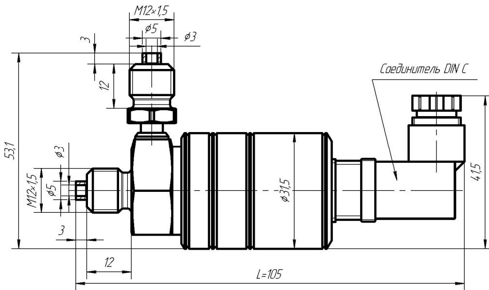
Рисунок Д.4 – Габаритные и присоединительные размеры датчиков МИДА-ДД-15-М12, МИДА-ДД-15-Ex-М12 с выходным сигналом в виде напряжения постоянного тока, наличием пропорциональной зависимости от напряжения питания и отсутствием элементов подстройки U0 и Ud (код сигнала 055, 057), а также датчиков с цифровым выходным сигналом (коды сигнала 061-064)
