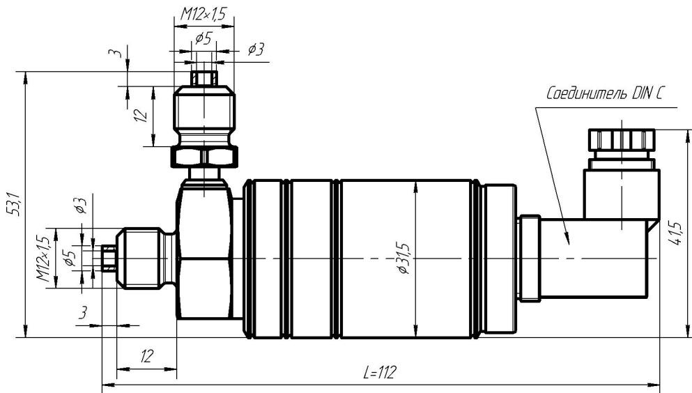
Рисунок Д.2 – Габаритные размеры датчика МИДА-ДД-15, МИДА-ДД-15-Ex с токовым
