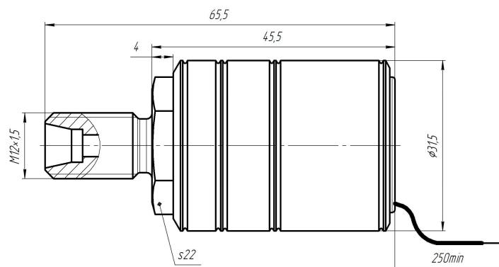
Рисунок Д.8 – Габаритные и присоединительные размеры датчиков МИДА-ДА-15-М12-2-А, МИДА-ДА-15-Ex-M12-2-А с выходным сигналом в виде напряжения постоянного тока и наличием пропорциональной зависимости от напряжения питания (код сигнала 057).
