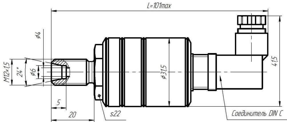
Рисунок Д.5 – Габаритные и присоединительные размеры датчиков МИДА-ДА-15-М12-2, МИДА-ДА-15-Ex –М12-2 с цифровым выходным сигналом (код сигнала 061-064)
