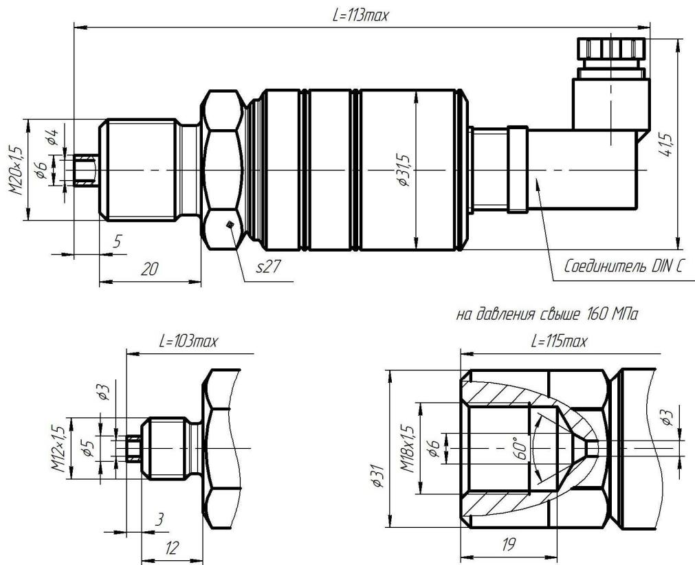
Рисунок Д.3 – Габаритные и присоединительные размеры датчиков МИДА-ДИ (ДА, ДВ, ДИВ)-15, МИДА-ДИ (ДА, ДВ, ДИВ)-15-Ex с токовым выходным сигналом (код 001), в виде напряжения постоянного тока и наличием пропорциональной зависимости от напряжения питания (коды сигнала 055, 057), а также датчиков с цифровым выходным сигналом (код сигнала 061-064). У всех исполнений отсутствуют элементы (резисторы) подстройки «нуля» и «диапазона». Методы настройки датчиков приведены в приложениях И, К, О.
