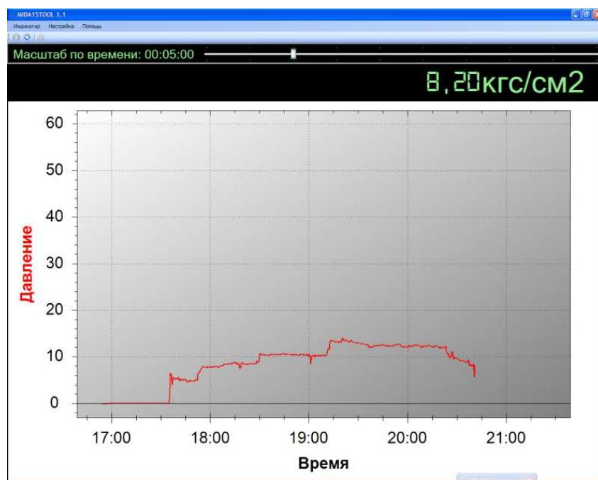
Рисунок И.4 – Вывод измеренного давления
