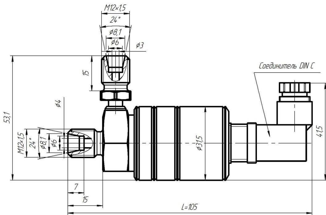
Рисунок Д.6 – Габаритные и присоединительные размеры датчиков МИДА-ДД-15-М12-2, МИДА-ДД-15-Ex-М12-2 с выходным сигналом в виде напряжения постоянного тока, наличием пропорциональной зависимости от напряжения питания и отсутствием элементов подстройки  $U_0$  и  $U_d$  (код сигнала 055, 057), а также датчиков с цифровым выходным сигналом (коды сигнала 061-064)
